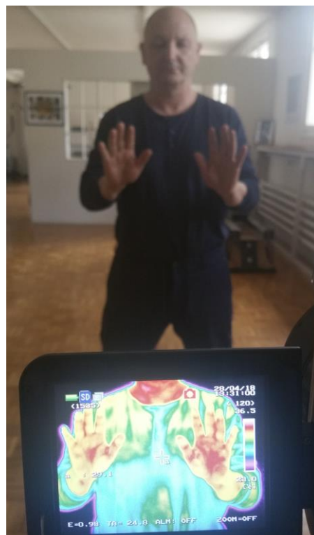
Abb.1 Messprinzip mit einer Infrarotkamera zur Überwachung der Temperaturverteilung des zu untersuchenden Körperteils des Patienten: in diesem Fall den Händen des Seiki-Therapeuten, Herrn Damljanovic.
